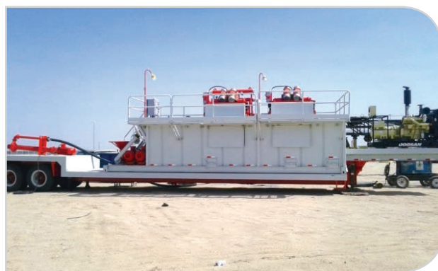
Система регенерации бурового раствора бурения водяной скважины
