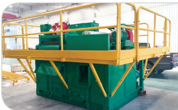
Система разделения бурового раствора горнодобывающей бурения
